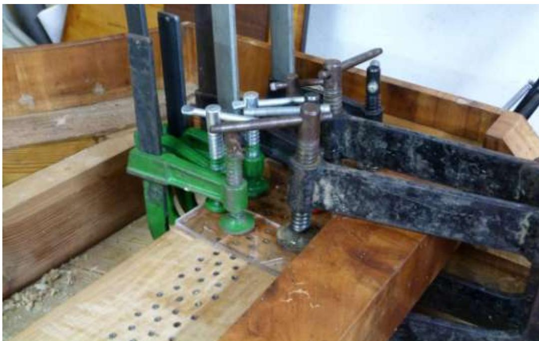
Somiere restaurato. I fori sono stati chiusi e riformati per ritrovare la cilindrit  dell'alveo.
