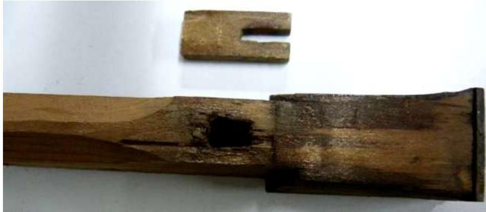
Le guide lignee delle forcelle erano scollate. E' stato necessario riconsolidarle e incollarle nuovamente sul tasto . Solo a quel punto si poteva avvitare la forcella. Originariamente lo strumento aveva forcelle lignee che verso la metà dell' '800 sono state sostituite con forcelle di ottone. Abbiamo deciso di mantenere quelle attuali perché il cambiamento era stato fatto per garantire una miglior efficienza dello strumento.
